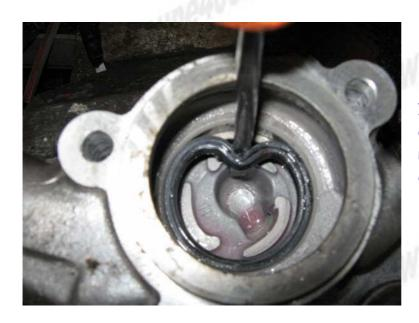
Il faut retirer le joint au fond du logement et en mettre un neuf. Il n'est pas fourni avec le calorstat neuf.
