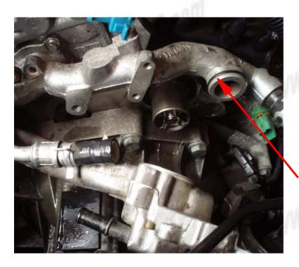
Il suffit de démonter seulement le bloc du calorstat et tout ce qu'il s'y rapporte. Il se dissocie très facilement du second bloc en faisant levier entre les 2 avec un tournevis par exemple.
