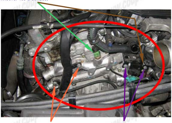
Démonter également les vis (Tête hexagonale de 13) qui maintiennent la gaine plastique du faisceau et celles (10) maintenant la plaque métallique.
