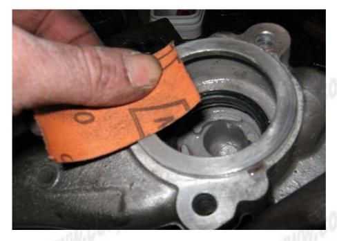
Nettoyage du plan de joint du calorstat. Ne gratter pas trop.
